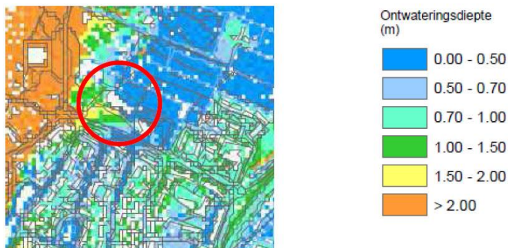
Afbeelding 10: Ontwateringdiepte in meter in een representatieve natte periode.
